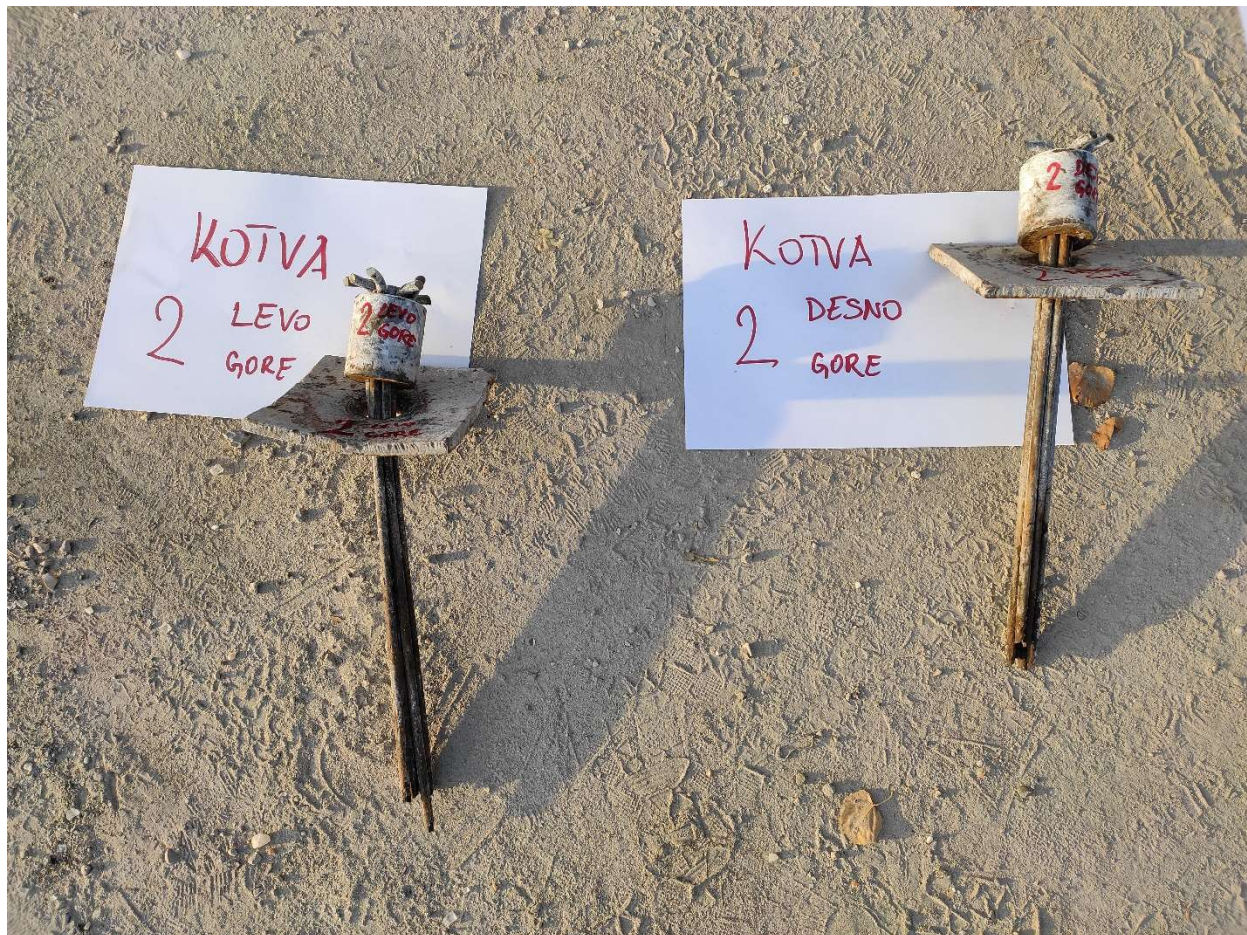
Фотографија 2.18. Котве 2-лево и 2-десно извађене из кровне конструкције – оса 2 (8.11.2024.)
