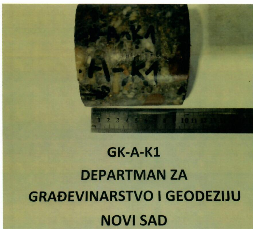
Slika 14 - Slika jezgra pripremljenog za ispitivanje čvrstoće pri pritisku
