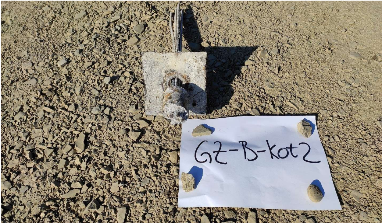
Фотографија 2.41. Котва 2 из армиранобетонске греде Б надстрешнице након вађења (5.11.2024.)
