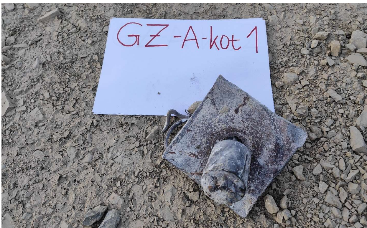
Фотографија 2.38. Котва 1 из армиранобетонске греде А надстрешнице након вађења – поглед на горњу страну котве (5.11.2024.)
