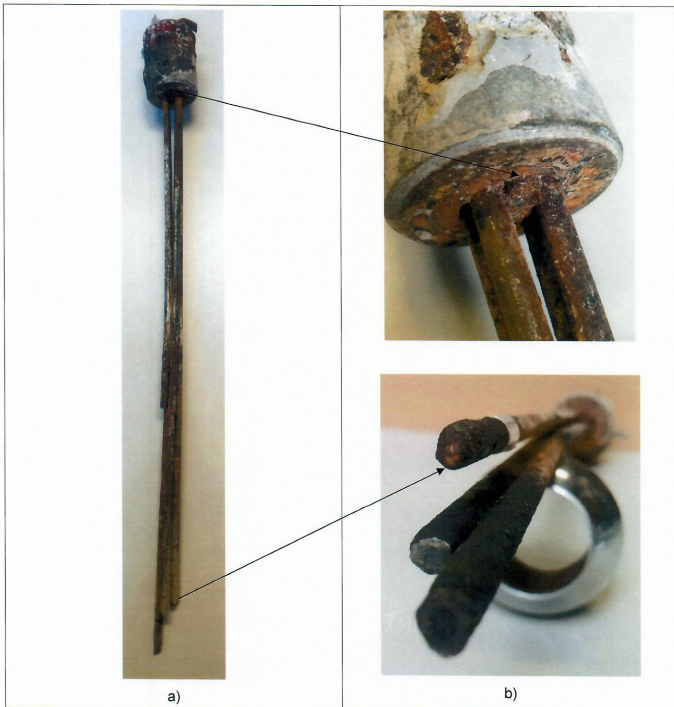
Slika 1. a) Kotva 4 Levo; b) žice sa oksidisanom prelomnom površinom
