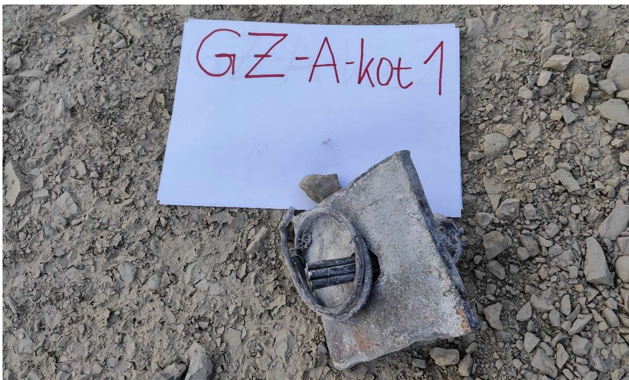
Фотографија 2.39. Котва 1 из армиранобетонске греде А надстрешнице након вађења – поглед на доњу страну котве (5.11.2024.)
