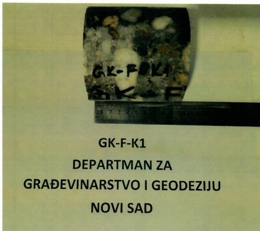
Slika 19 - Slika jezgra pripremljenog za ispitivanje čvrstoće pri pritisku
