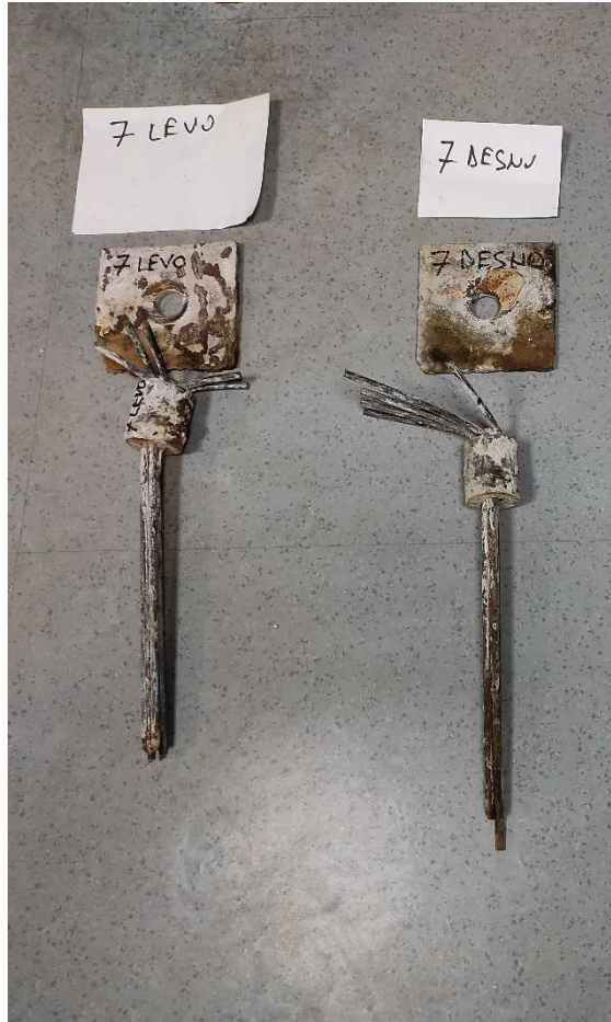
Фотографија 2.25. Котве 7-лево и 7-десно извађене из кровне конструкције – оса 7 (2.11.2024.)
